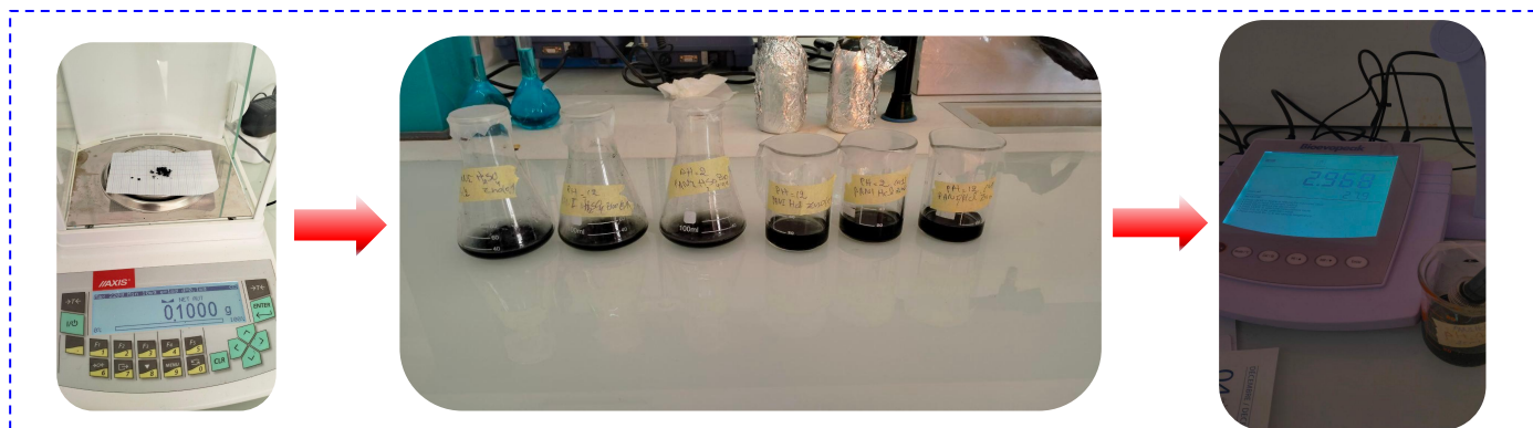
Figure II.12: Les étapes de l'étude du point de charge pH_{pzc} .
