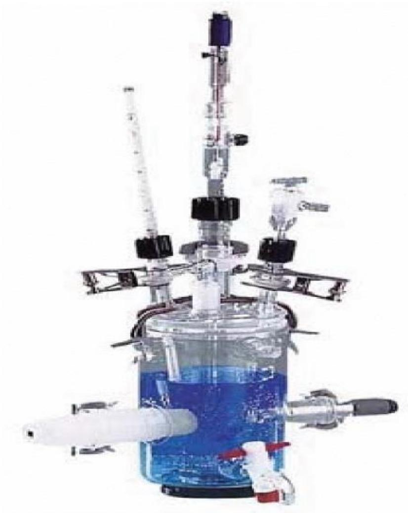
**Figure 1** : cellule électrochimique
