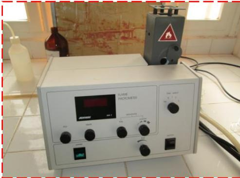
Photo N°3 - Spectromètre à flamme
