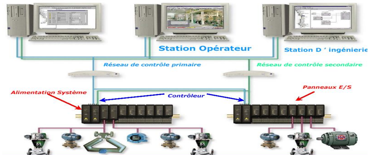
Figure. II.10. Architecture du système Delta V.
