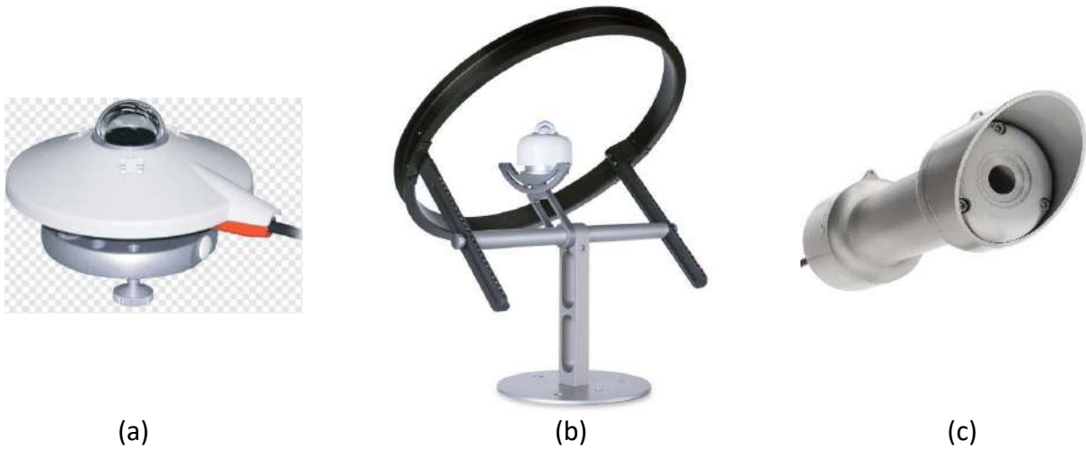
Figure 2.4 : Instruments de mesures radiométriques : a - Pyranomètre, b - Pyranomètre avec ombrage, c - Pyréliomètre.
