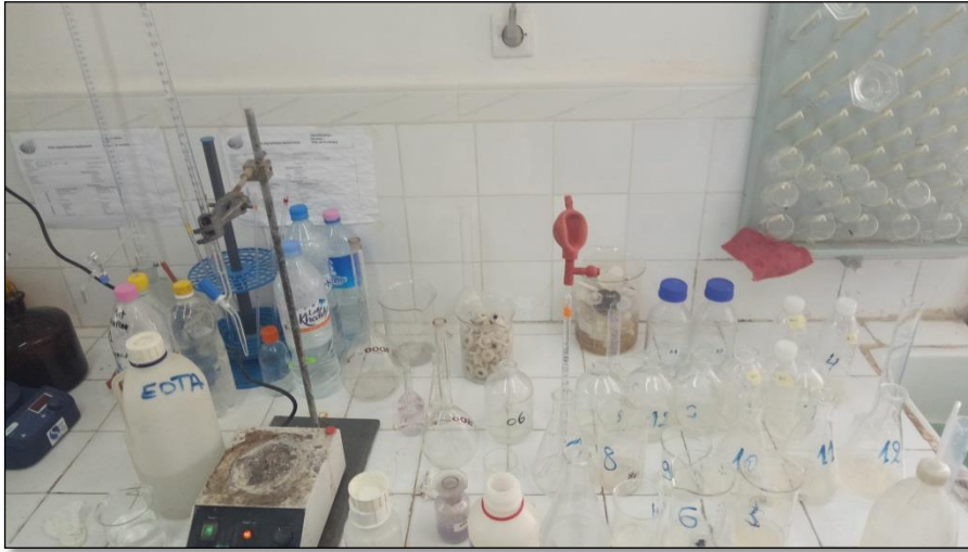
الشكل 26: مراحل المعايرة و الكشف عن تركيز الكالسيوم.
