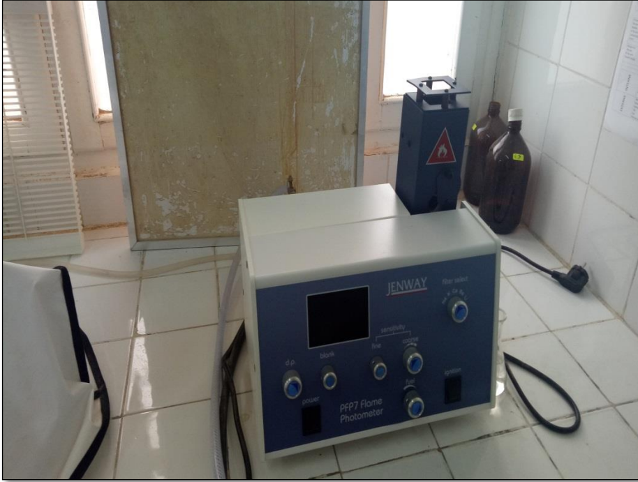
الشكل 24: جهاز قياسات اللهب (Photométrie à Flamme)
