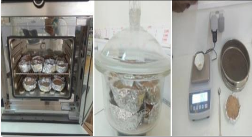
الشكل 19: مراحل قياس كمية الكلس في التربة.
