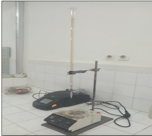
الشكل 22: اجراء عملية معايرة AgNO_3
