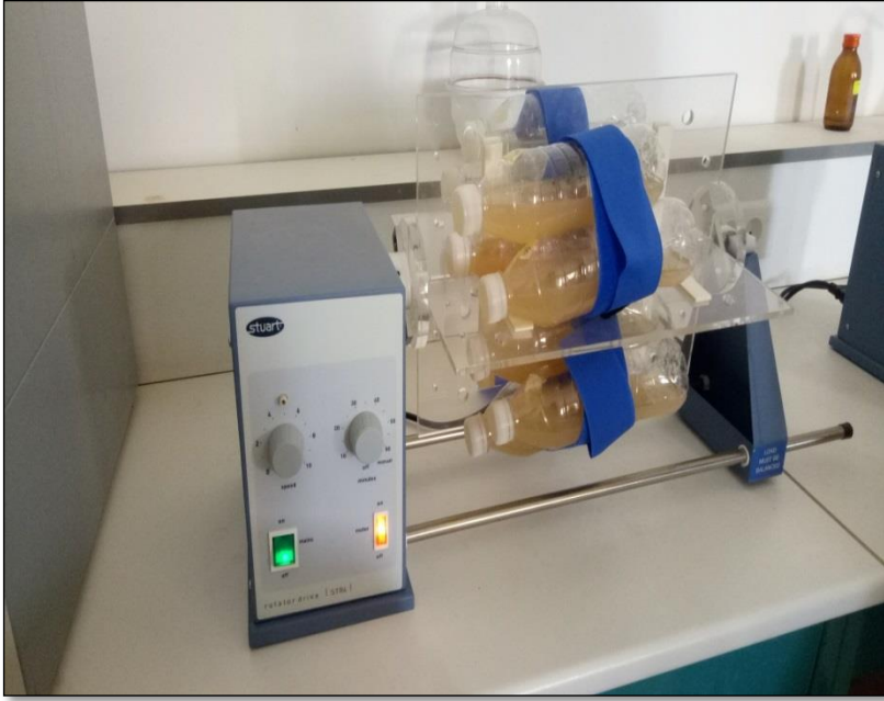
الشكل 16: صورة توضح جهاز الرج مثبت فيه العينات من المستخلص المائي 5\1.
