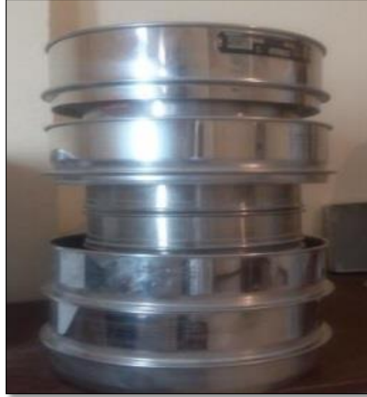
الشكل 15: غربال التحليل الحبيبي للتربة.
