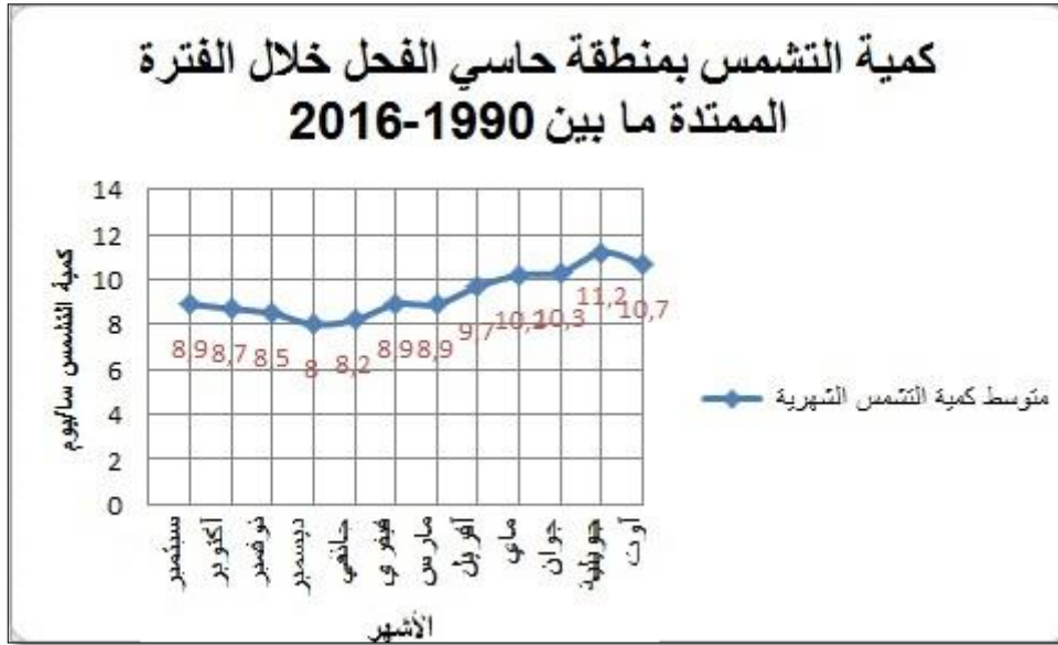
الشكل 6: منحني يوضح متوسط الشمس اليومي بمنطقة حاسي الفحل ( الساعات \ اليوم ) خلال الفترة الممتدة ما بين السنوات (1990-2016) [11]
