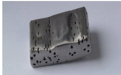
figure I.7 : Corrosion par un pique .
