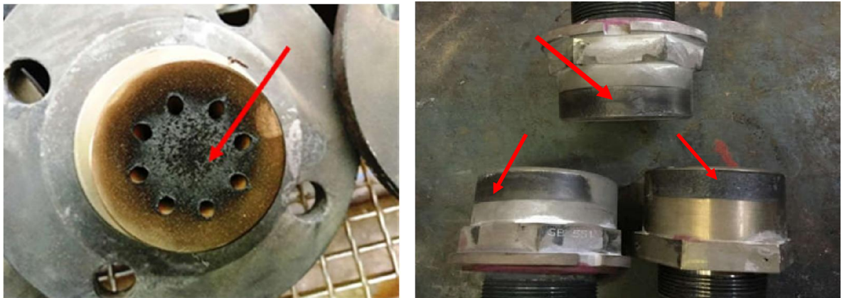
Figure IV.2 : Dépôt calamine et usure sur les nez
