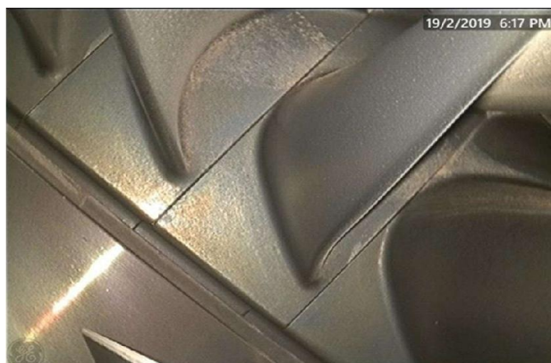
Figure IV.11 : Aubes de la roue BP
