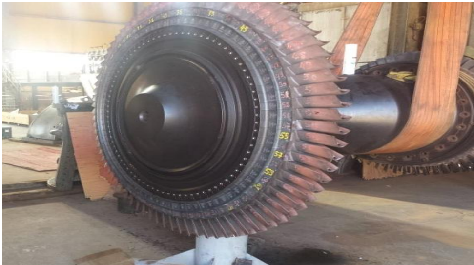
Figure II.6 : La roue HP de premier étage
