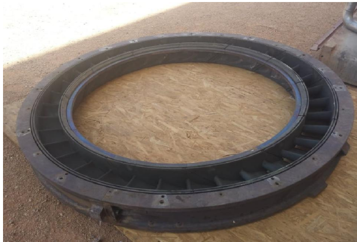
Figure II.5 : La Directrice fixe de premier étage
