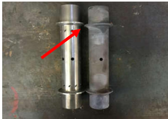
Figure IV.5 : différence de longueur des tubes d'interconnexion
