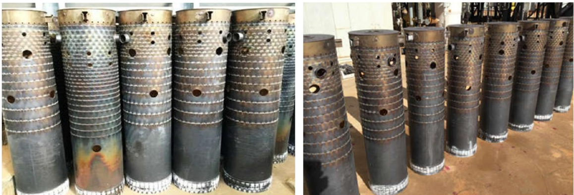
Figure IV.6 : Tubes à flamme
