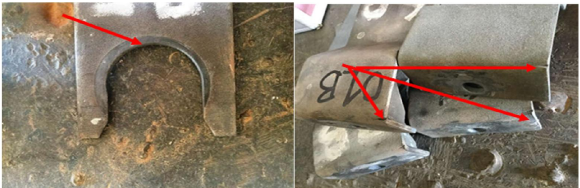
Figure IV.3 : Usure des lèvres sur la fourchette et fissure de trois pièces
