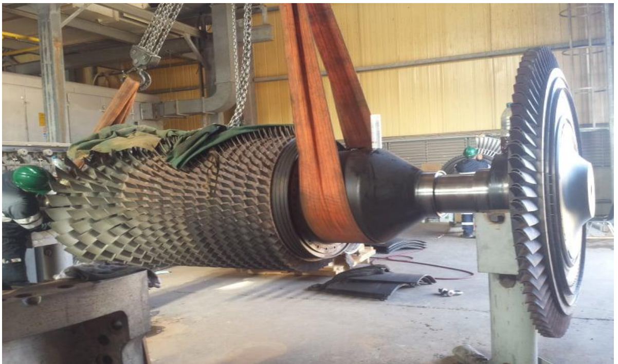
Figure II.2 : Corps de compresseur axial de la TAG Ms5002b
