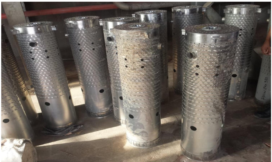
Figure II.4 : Les tubes à flamme de la TAG Ms5002b
