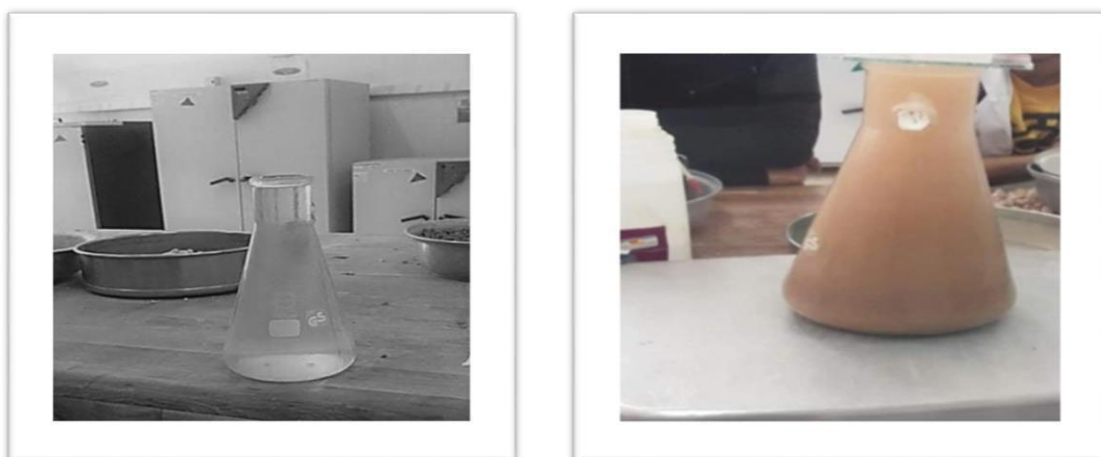
Figure (III.04) : Essais de la Masse volumique absolue du sable.
