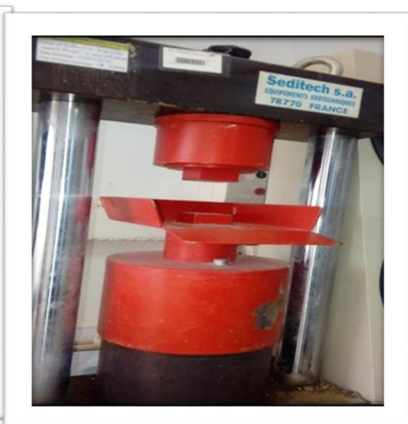
Figure(III.11) : Essai de la résistance à la compression.
