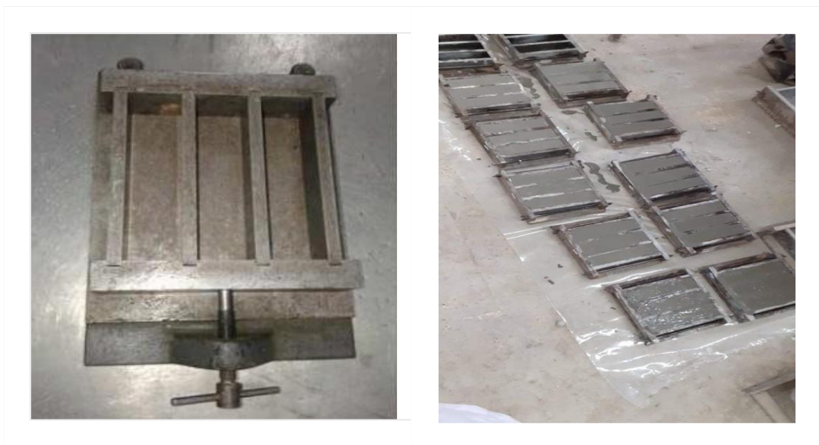
Figure (III.08) : Moule de mortier utilisé vide et rempli.
