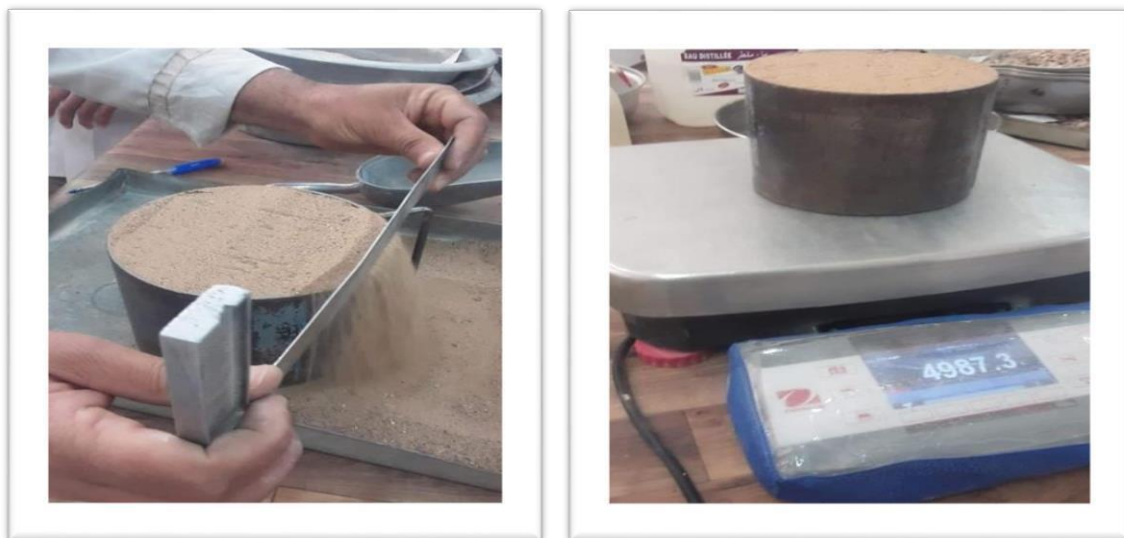
Figure (III.05): Essai de la Masse volumique apparente du sable.
