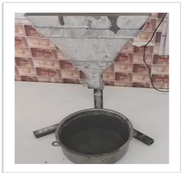
Figure (III.10) : Essai de l'entonnoir en V (V-Funnel).
