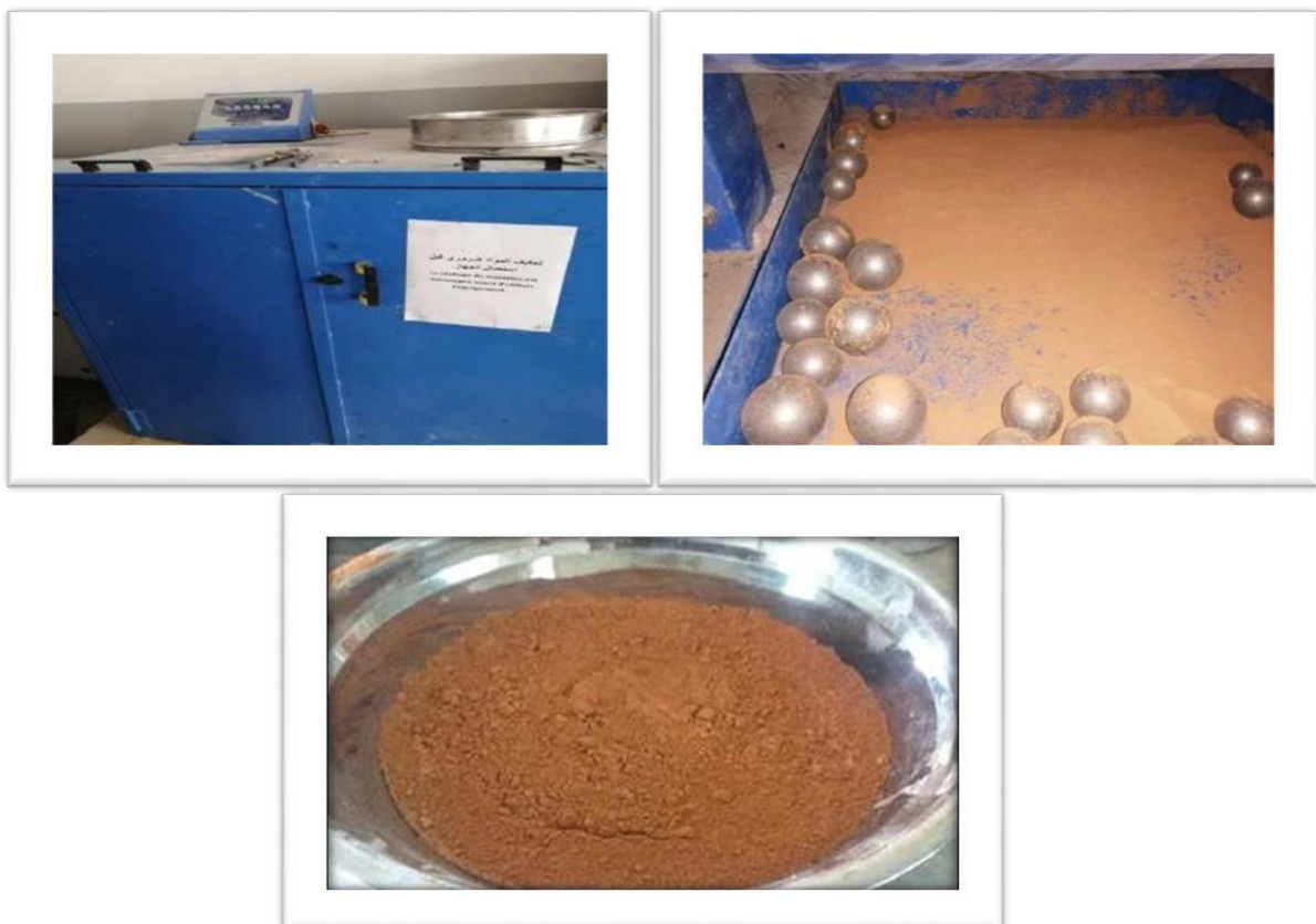
Figure (III.01) : Processus de broyage des déchets céramiques.
