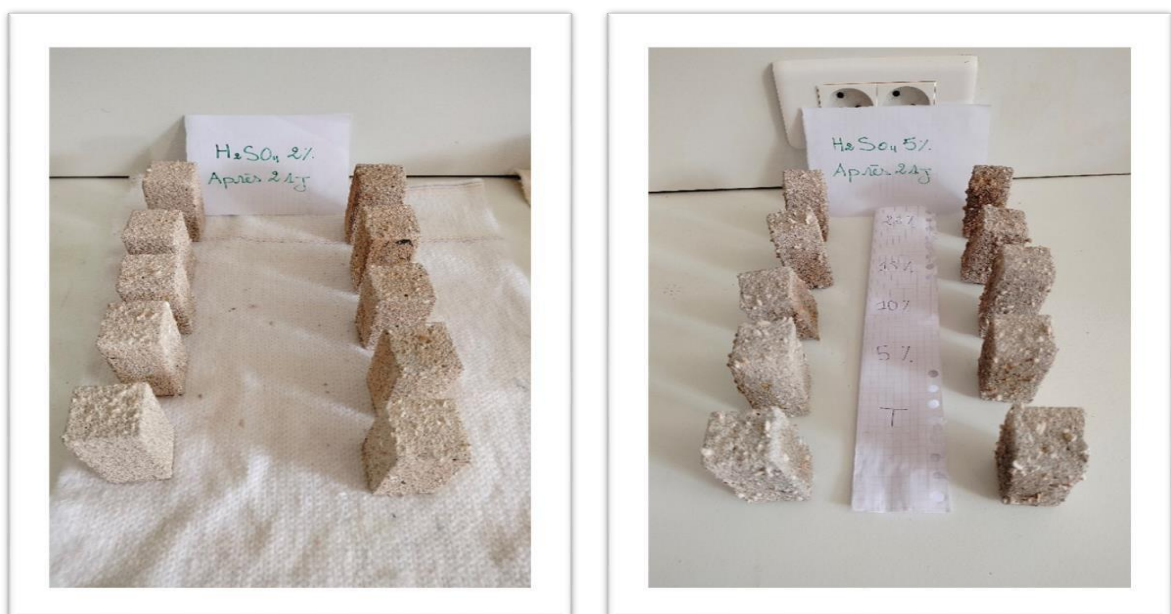
Figure (VI.07) : Degré d'attaque par l'acide sulfurique.
