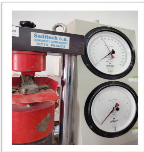
Figure(III.11) : Essai de la résistance à la compression.
