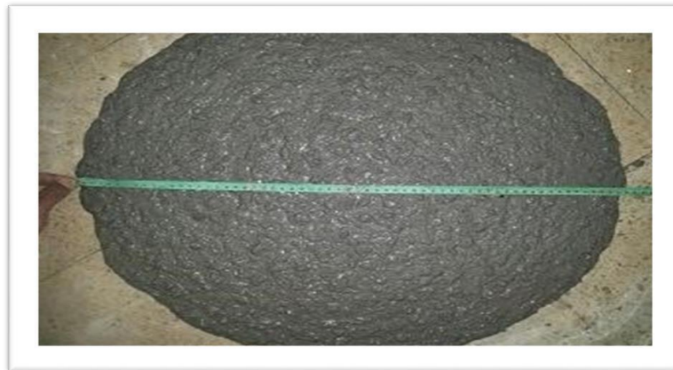
Figure(III.09) : Essai de Mini cône à mortier.
