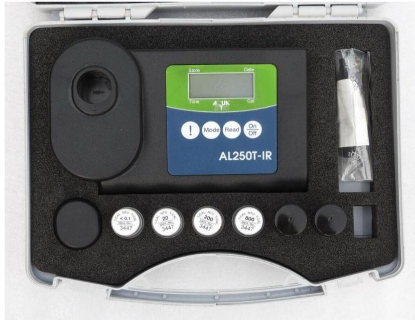
Photo N° 20: Turbidimètre type AL250T-IR
