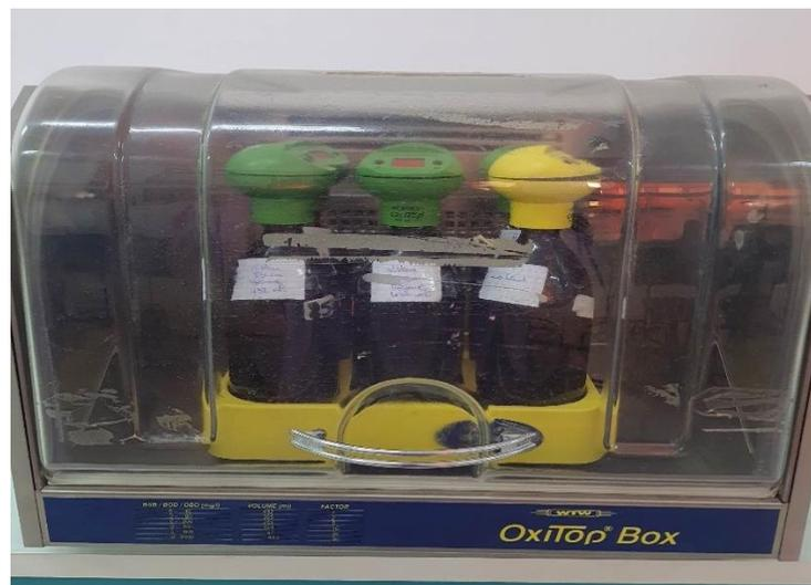
**Photo N° 22: DBO-mètre type WTW-OXTTOP**
