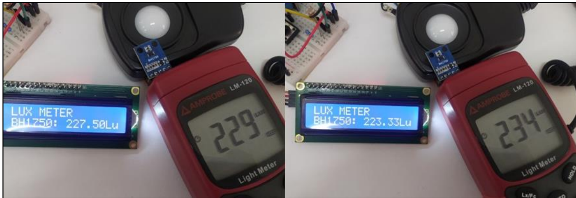
Figure 3- 25: Comparaison des valeurs BH1750 et Luxmètres.
