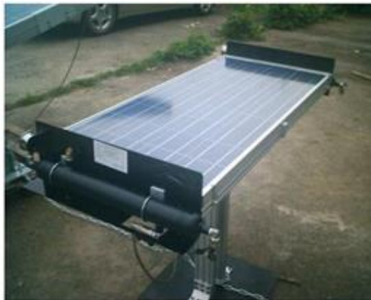
Figure 2-2: Suiveur solaire passif.
