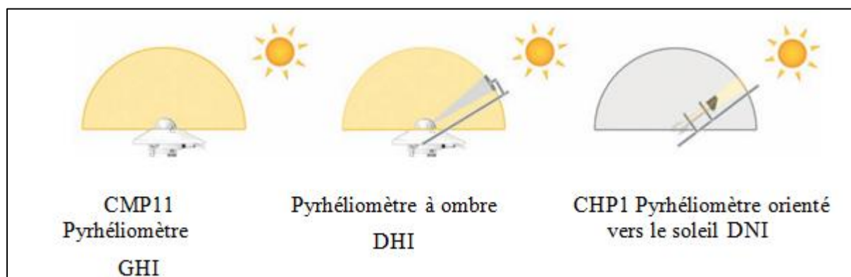
Figure 1- 8: le principe de fonctionnement du tracker solaire Solys2.
