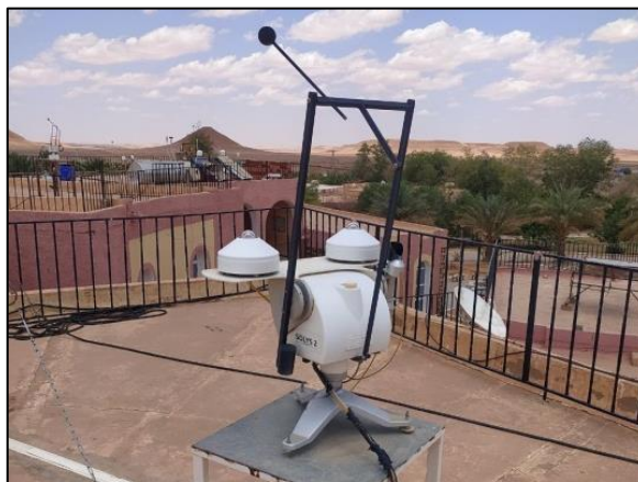
Figure 1- 7: Le tracker solaire Solys2 de L'URAER.
