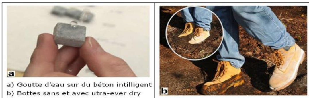
Figure. II. 8. Béton intelligent bottes sans et avec traitement ultra-ever dry
