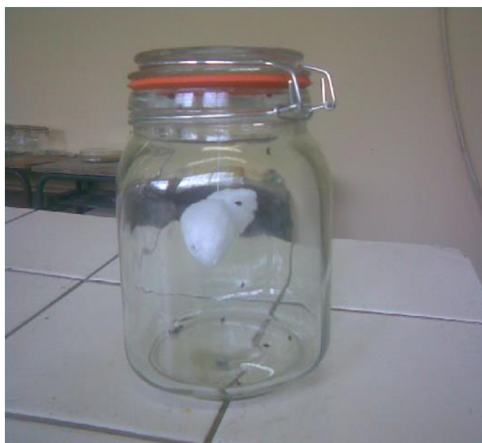
Figure 32 : Dispositif expérimental des tests d'inhalation.(AIBOUD,2012)
