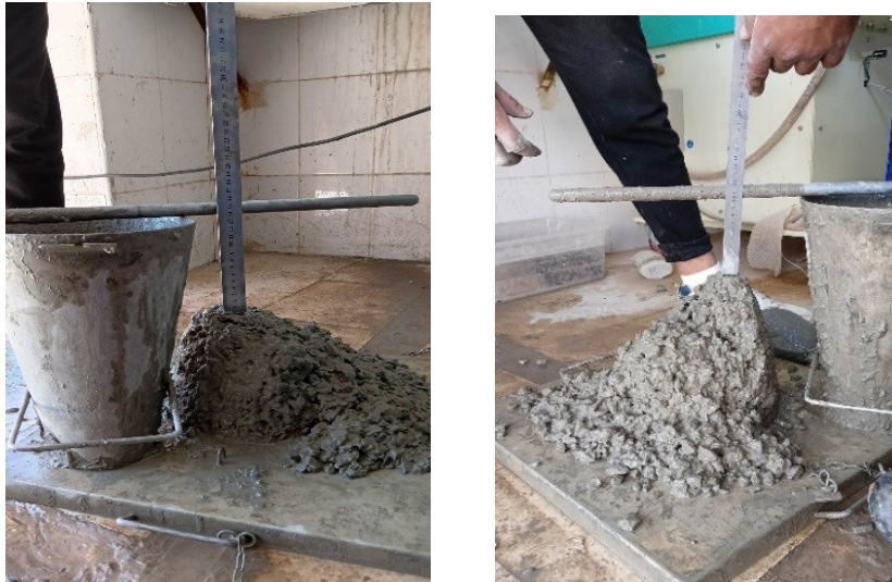
Photo. II.9 . Mesure de l'affaissement à l'aide du cône d'Abrams.
