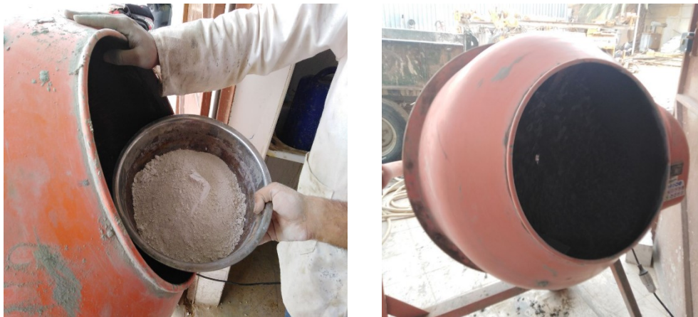
Photo II.7. Ajout des fines de SC dans le malaxeur.
