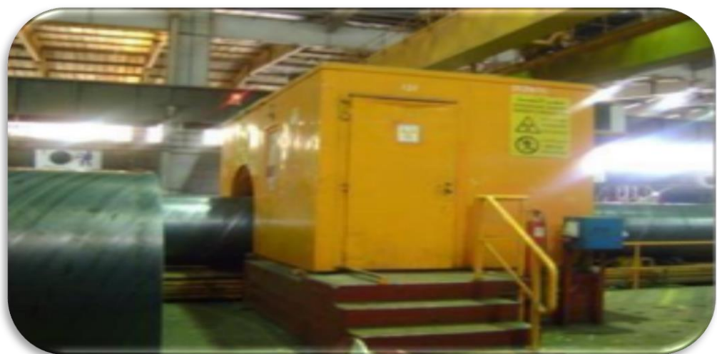
FIG.I.10. Contrôle de la soudure par radioscopie. [5]
