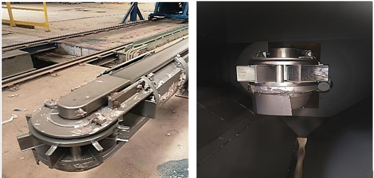
FIG.III.5. La lance et Turbine de grenailage
