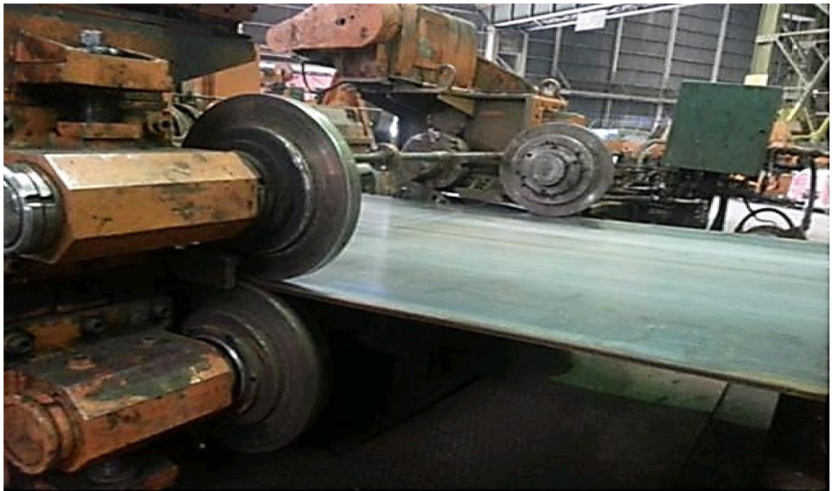
FIG. I.6. couper les languette de fin de bande [5]
