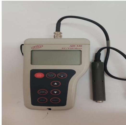
**Figure III.10:** Conductimètre
