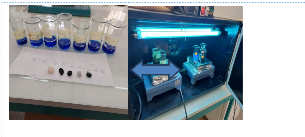
Figure II.16: Montage dispositif (chambre noire) du processus de la photodégradation par les composites et les éponges. (photo mobil)
