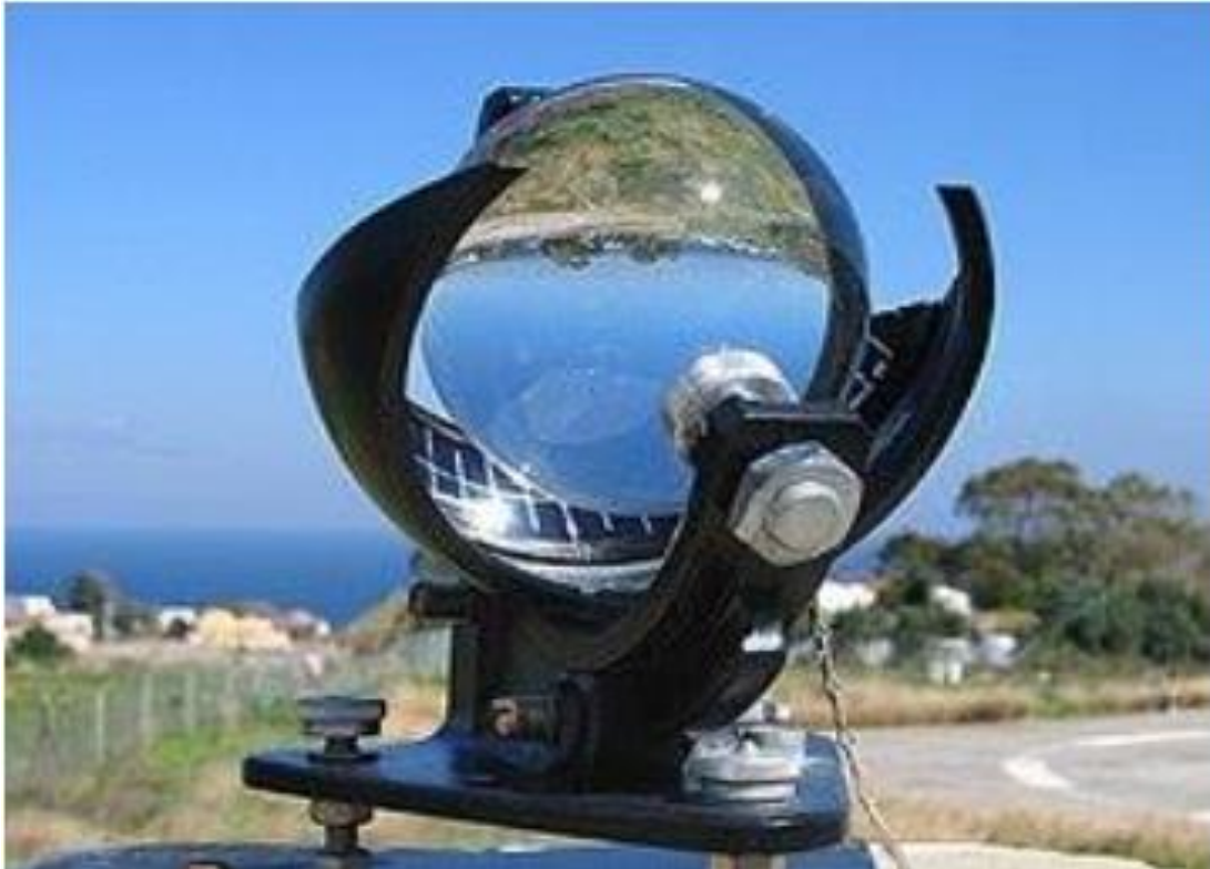
Figure (1- 19) : Héliographe de Campbell-Stockes [4].
