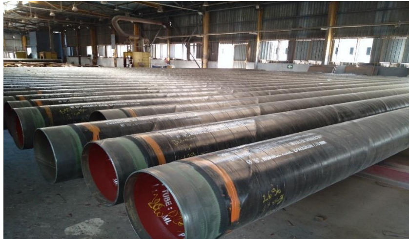
Figure I. 4 Revêtement de tube à l'extérieur.
