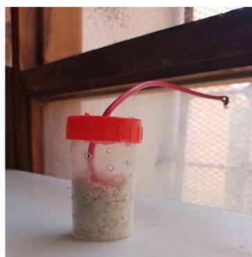
Figure 32 : Anode de zinc introduit dans le backfill de cellulose
