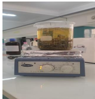
Figure 22 : Elimination de sucre et les impuretés de Alfa
