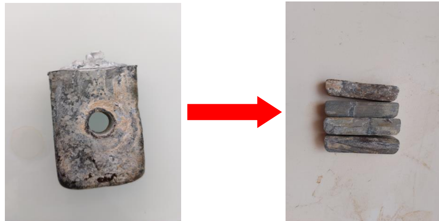
Figure 29 : les électrodes (anodes) de Zinc
