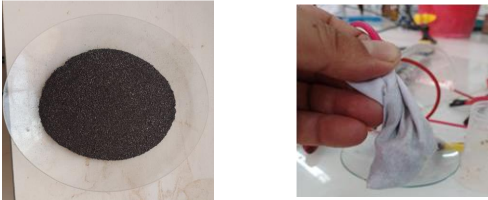
Figure 33 : le backfill commerciale et l'installation de l'anode au pochette intérieur de toile
