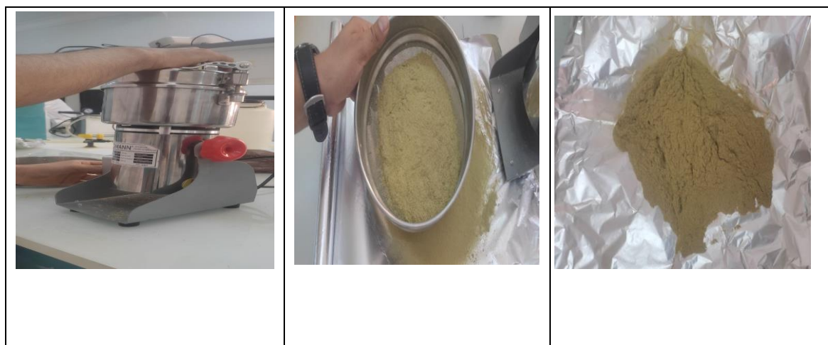
Figure 24 : Broyage et tamisage de farine d'Alfa
