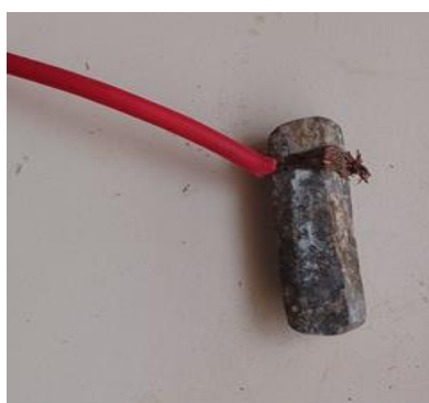
Figure 32 : Anode de zinc introduit dans le backfill de cellulose
