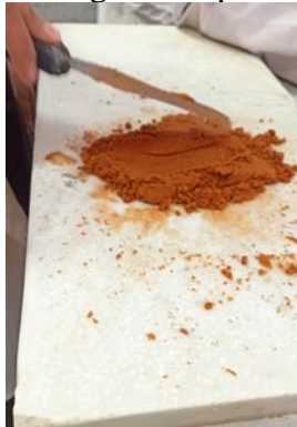
Photo II.7 : Les tapes de l'essai limite de liquidité.
