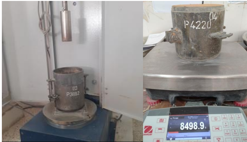
Photo II.11 : Procédure d'essai Proctor Modifié
