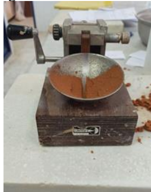
Photo II.7 : Les tapes de l'essai limite de liquidité.
