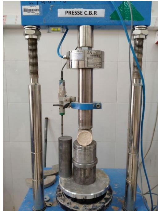
Photo II.14: Procédure d'essai traction.
