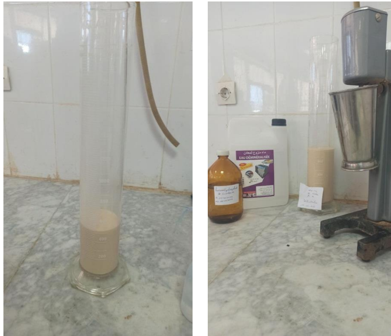
Photo II.4 : Analyse granulométrique par sédimentométrie (fines calcaire).
