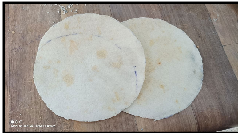
Photo IV.5 : Le géotextile AS30 non tissé Source : l'auteur
