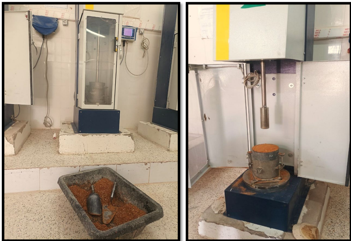
Photo IV.2 : Une image montrant l'appareil Proctor utilisé et quelques autres outils. Source : l'auteur
