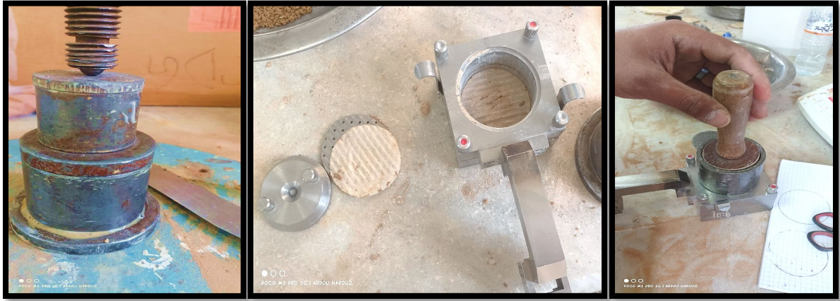
Photo IV.6 : Des Étapes pour préparer la boîte circulaire et l'échantillon
