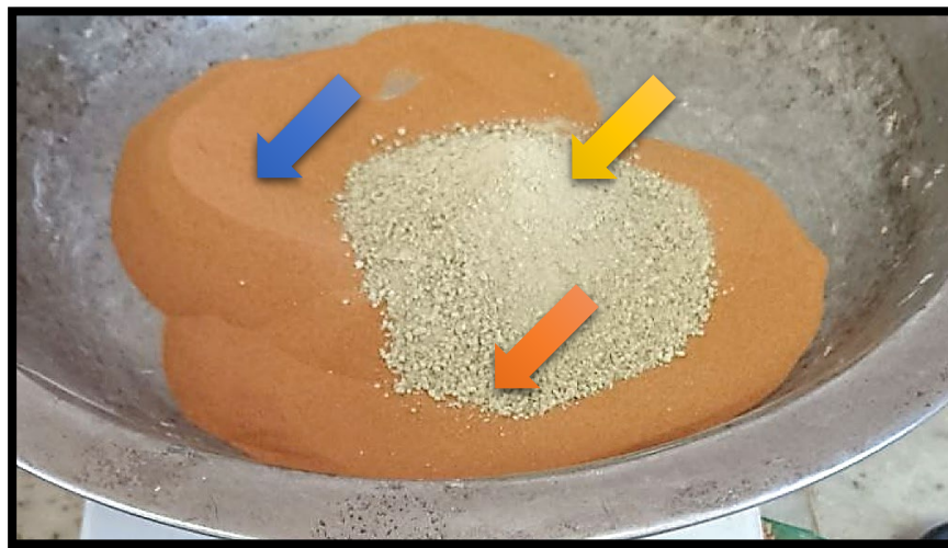
Photo IV.9 : la Différence notable dans les diamètres des composants du mélange
