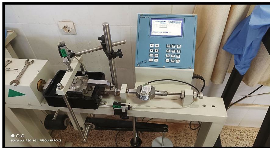
Photo IV.7 : L'appareil de cisaillement utilisé dans notre étude (NF P94-071-1)
