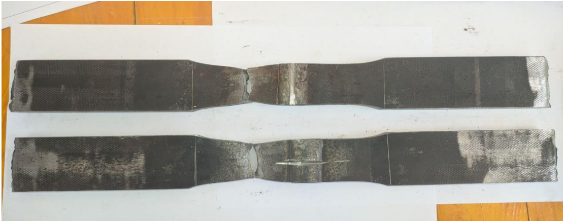
Fig. IV.17 : Résultats de l'essai de traction (l'entaille transversale et longitudinale)
