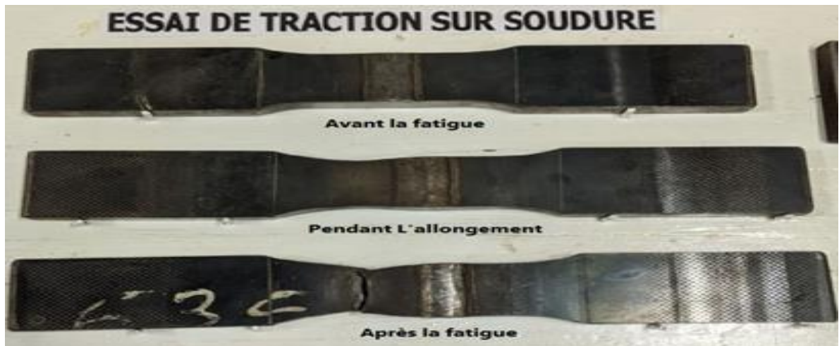
Fig. IV.27 : Essai de traction sur soudure
