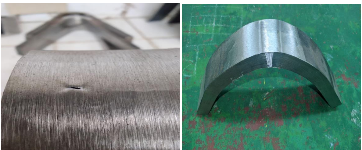
Fig. IV.28 : Exemple de fissure après le pliage
