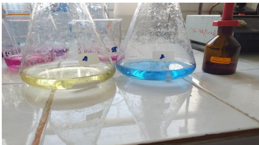
Figure 06 : virage de l'indicateur coloré lors du dosage de titre alcalimétrique complet (TAC)
