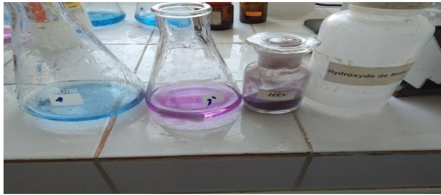
Figure 04 : virage de l'indicateur coloré lors du dosage de Calcium. (Originale, 2021)
