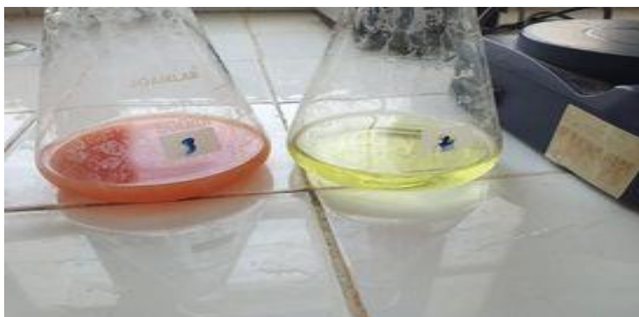
Figure 05 : changement de la coloration de l'échantillon analysé lors du dosage des chlorures. (Originale, 2021)
