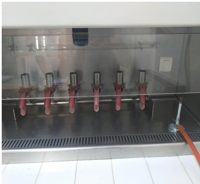
Les rampes de filtration
