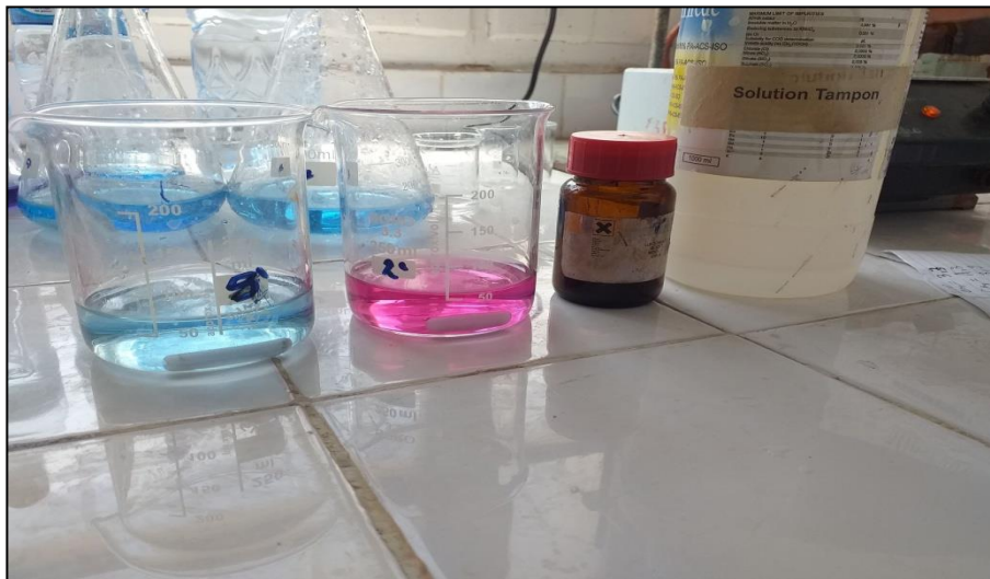
Figure 03 : Virage de l'indicateur coloré lors du dosage de la dureté. (Originale, 2021)
