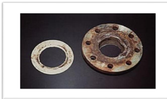
Figure I.2 : Corrosion caverneuse d'un acier allié sous un joint
