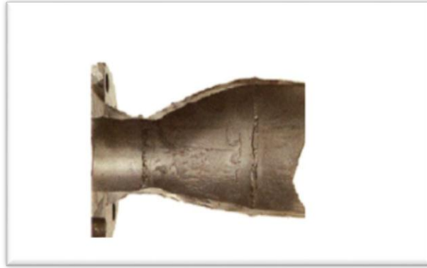
Figure I.6 : Corrosion-érosion dans une zone turbulente [19]
