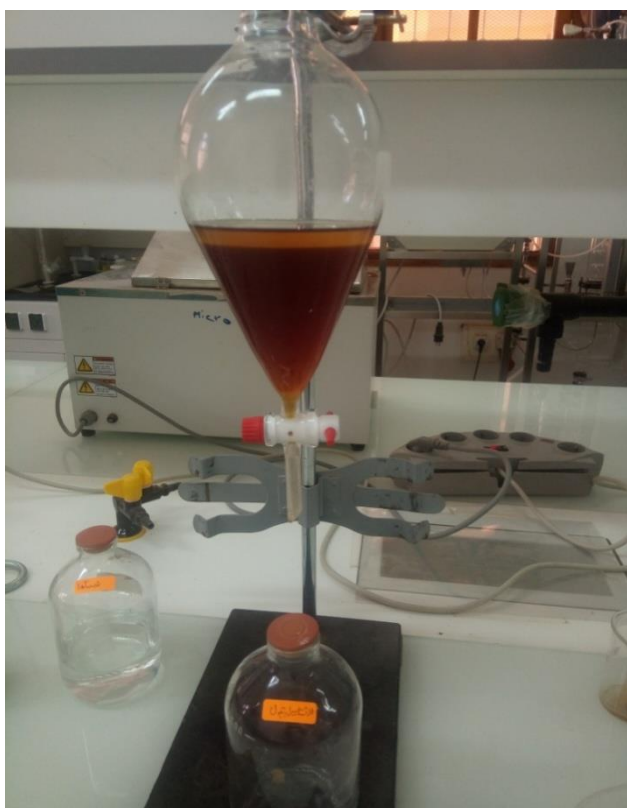
Photo 06 : l'extraction avec acétat
