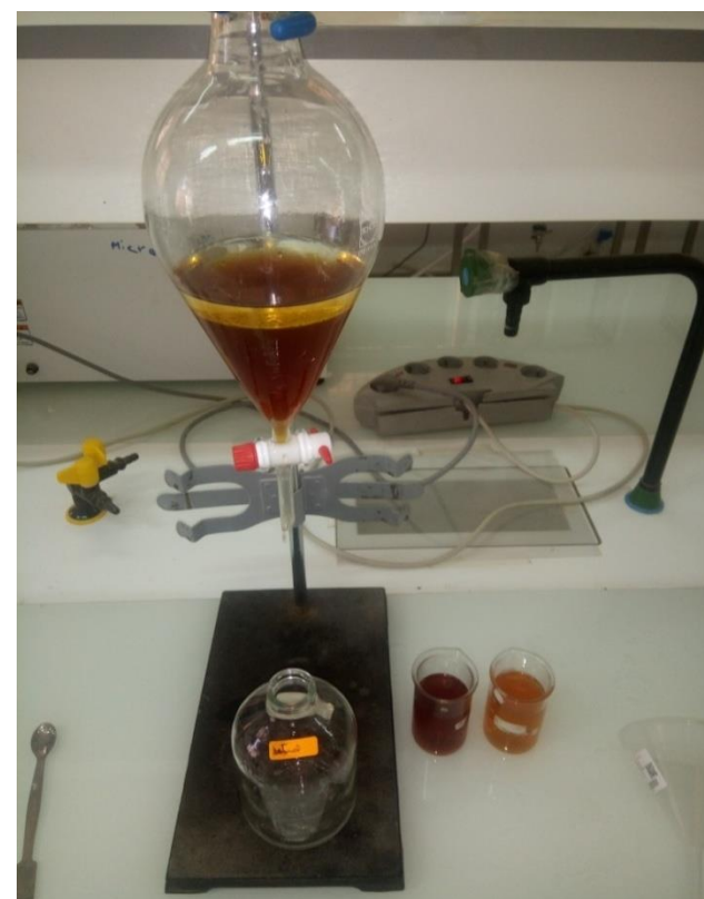
Photo 07 : l'extraction avec n-butanol
