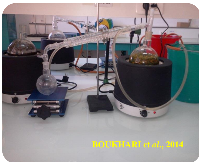
Photos n°3 : Montage d'hydrodistillateur
