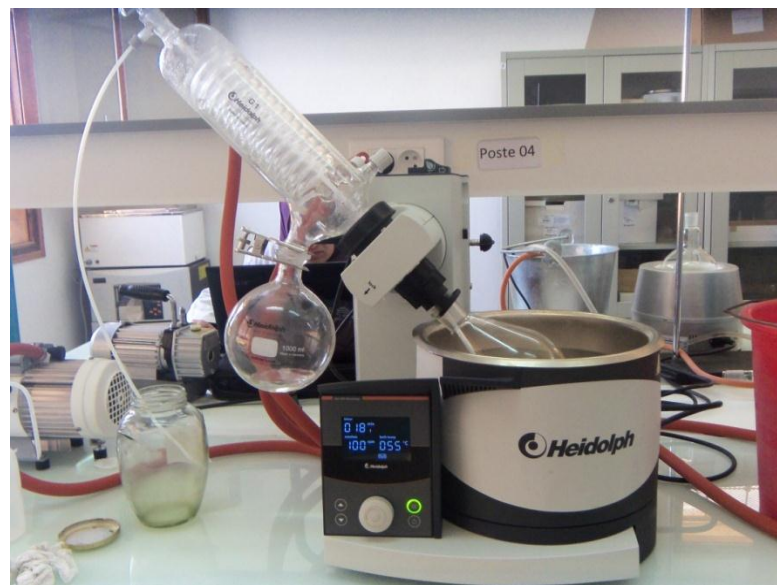
Photo 6 – Rotor vapor de type Heidolph (originale)
