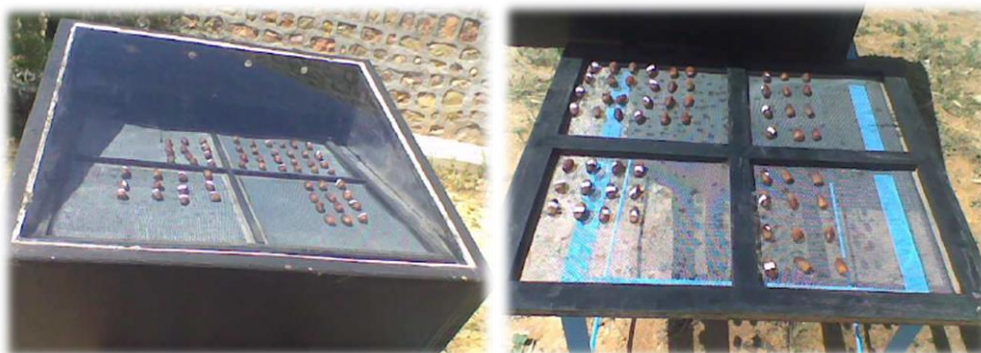
Figure 33 : (A) Séchage au rayonnement solaire, (B) Séchage à l'air libre (Mechlouch et al. , 2005).
