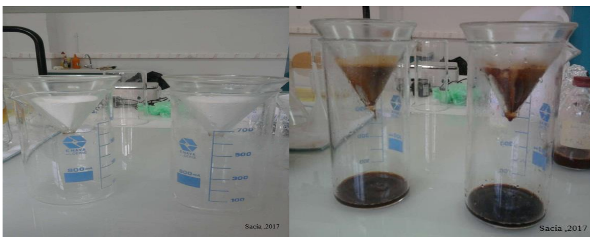
Photographie 08 : Filtration de la solution des pennes
