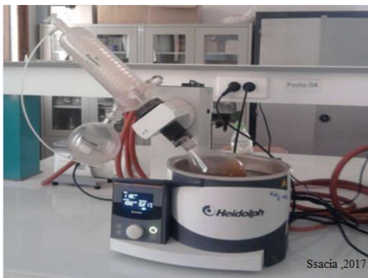
Photographie 09: Montage d'évaporation rotative par Rota vapeur (évaporation de l'éthanol)
