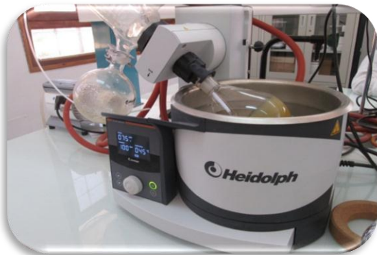
Eliminer le méthanol par d'un rotor vapor
