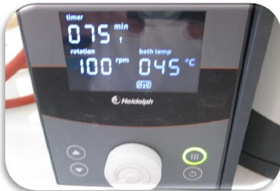
Eliminer le méthanol par d'un rotor vapor
