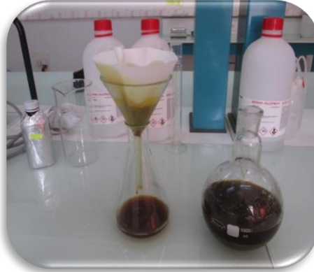
L'homogénat est refroidi et filtre à l'aide d'un papier filtre ordinaire
