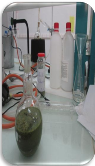
600 ml solution aqueuse de méthanol + 100 g matière végétale
