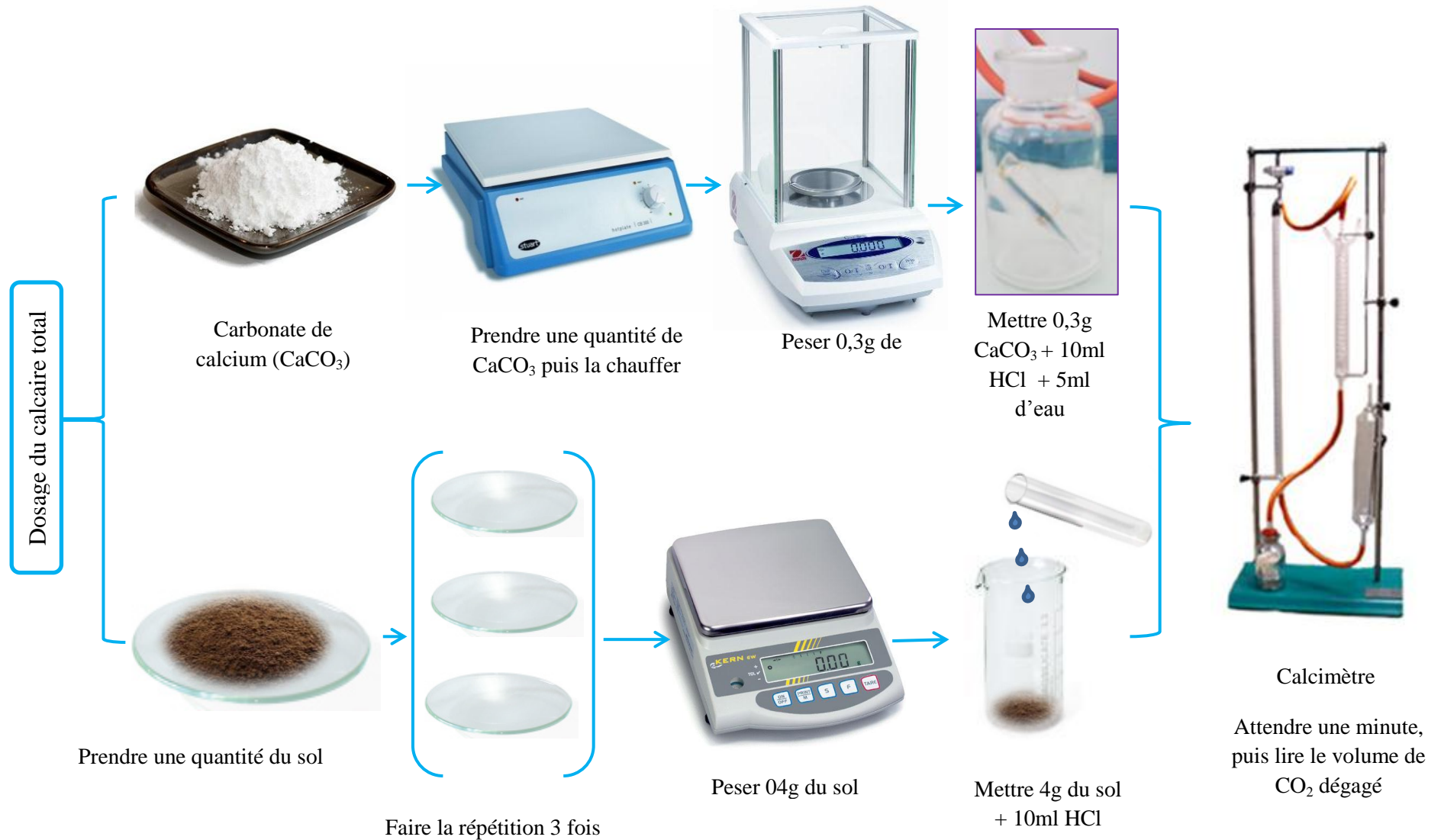
Figure 11. Dispositif expérimental du dosage du calcaire total dans le sol
