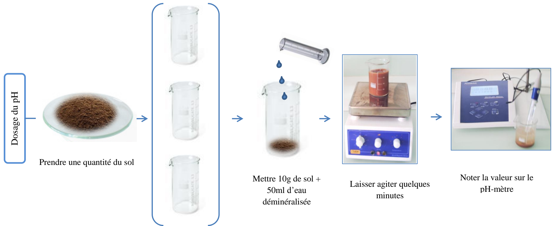
Figure 12. Mesure du pH dans le sol
