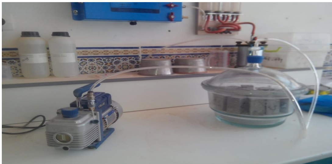
Figure 50 : VI. Montage pour la mesure de la porosité accessible à l'eau.
