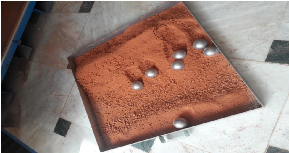
Figure I.12. Les granules des briques que nous avons obtenus De la machine los Anglos
