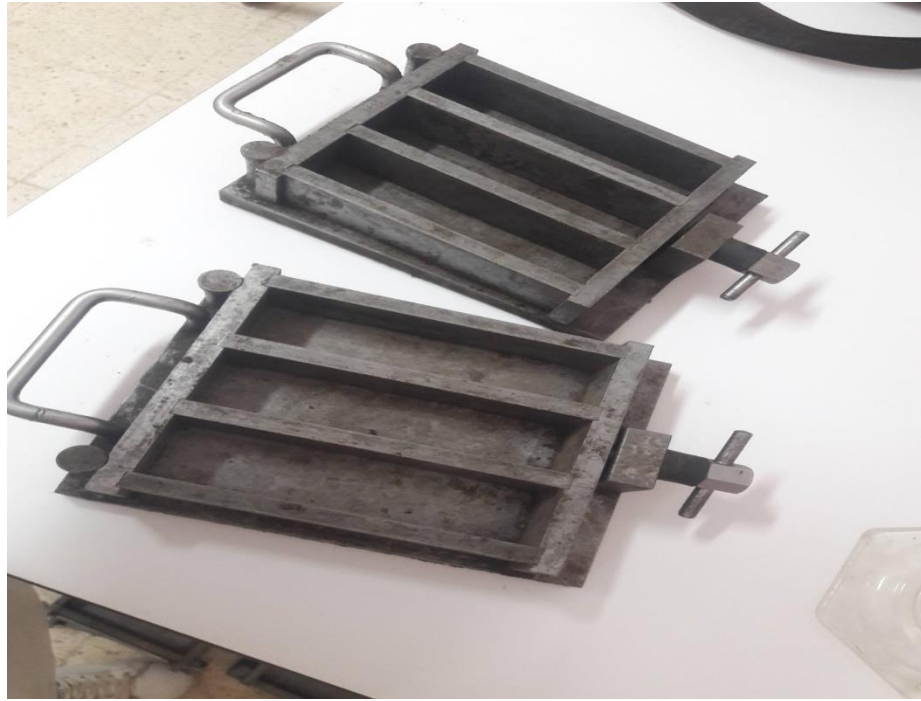
Figure 20:II. MOULE DE RETRAIT POUR MORTIER 40x40x160 mm
