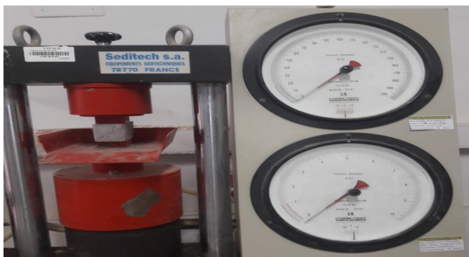
Figure 45:Figur VI. Dispositif de l'essai mécanique de Compression
