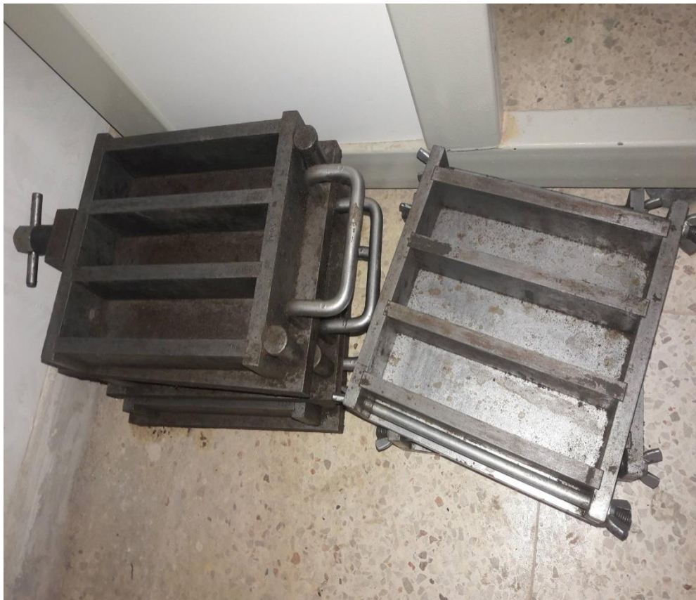
Figure 37: VI. Moule normalisé de 40x40x160 mm
