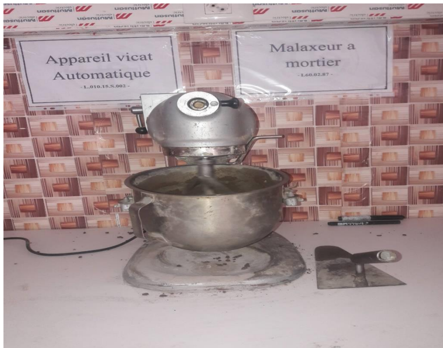
Figure 38:Vi. Malaxeur électrique utilisée dans la fabrication du mortier [Labo Béton –LTPS].
