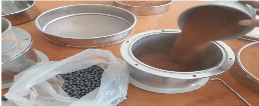
Figure I.13. Granulés de brique dans le Moule de la machine de Micro Duval avec granulés de fer
