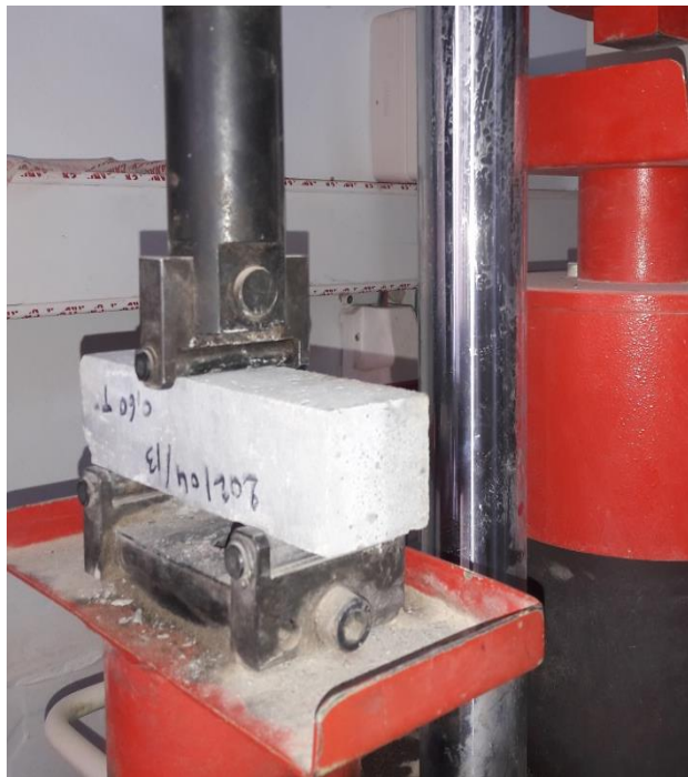
Figure 41:VI . Dispositif de l'essai mécanique de rupture par flexion (3 points)
