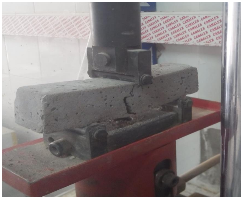
Figure 42: VI. Etat de l'éprouvette après l'essai de flexion (3 points)
