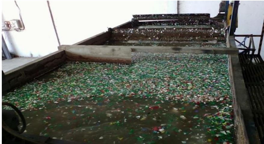
Figure I. 5: Bassin de séparation des paillettes en PET des impuretés.[11].
