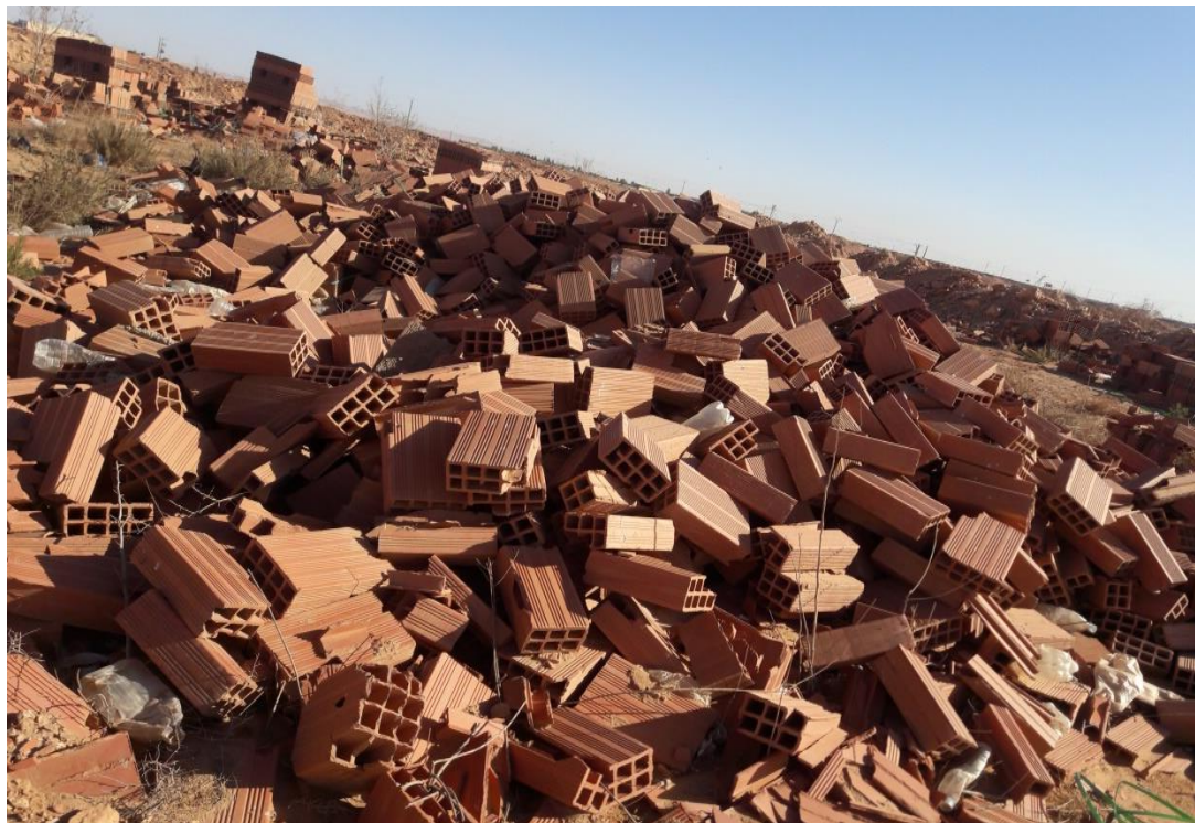
Figure I.9 .Remblai de déchets de briques dans une usine à Laghouat
