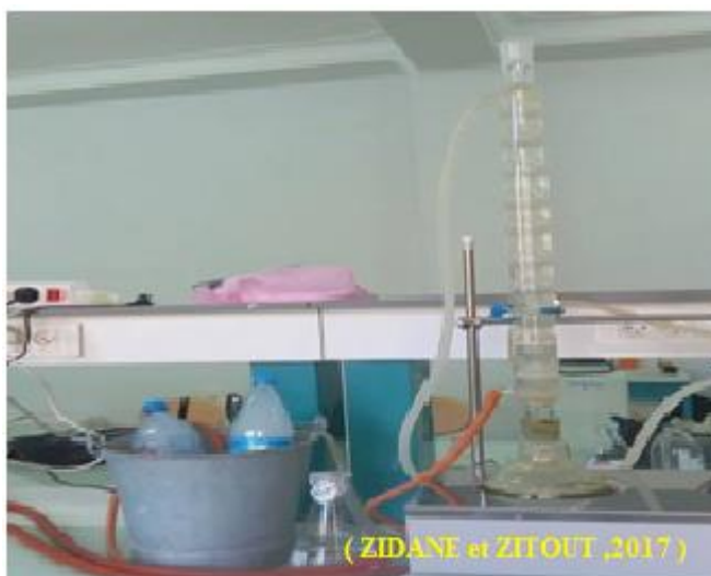
Photo 06- Dispositif d'extraction des principes actifs par reflux
