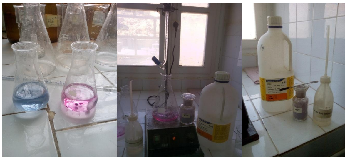
Fig.27 : solutions et matériel pour mesurée le calcium de l'eau (Originale, 2018).
