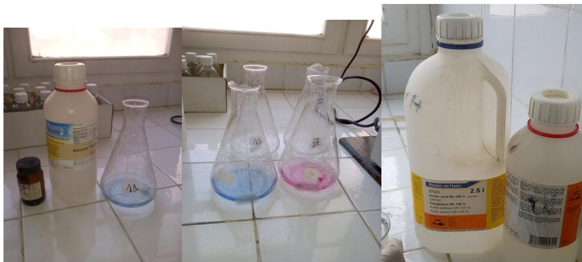
Fig.25 : solutions et matériel pour mesurée la dureté de l'eau (Originale, 2018).
