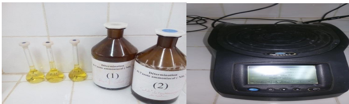
Fig.30 : solutions et matériel pour mesurée l'ammonium (Originale, 2018).
