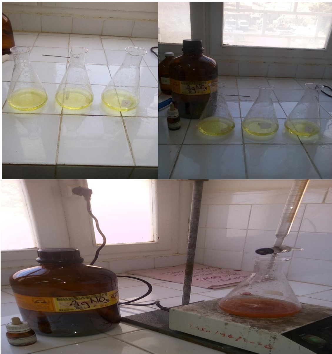
Fig.28 : solutions et matériel pour mesurée la Chlorures de l'eau (Originale, 2018).
