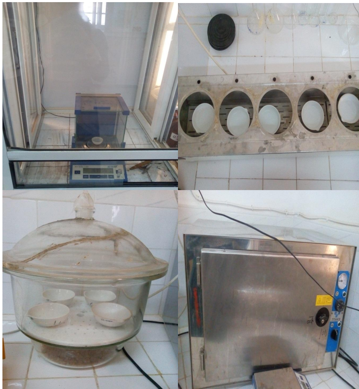
Fig.24 : matériels utilisé pour mesurer résidu sec de l'eau analysée (Originale, 2018).
