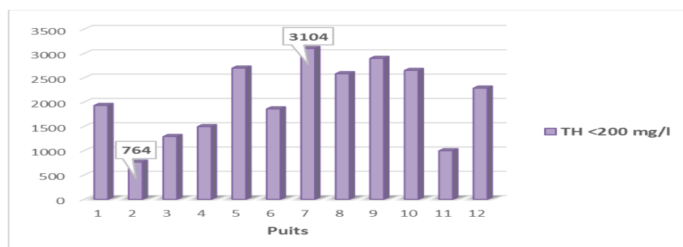
Figure 33. Variation de la dureté totale dans les eaux de puits.
