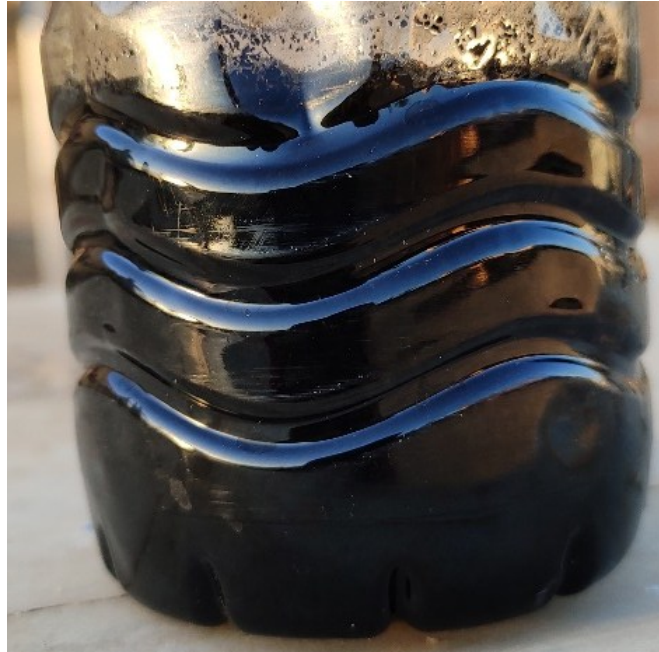
Figure III.9: Nano-fluide préparé à la base des nanoparticules (carbone homogène)
