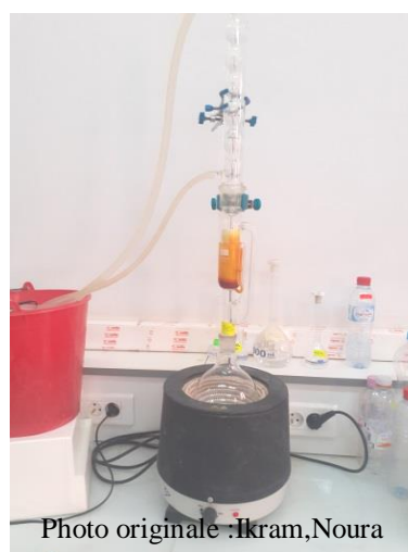
Figure IV.8: Les étapes d'extraction de la curcumine par montage de Soxhlet.
