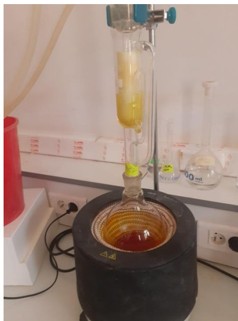
Figure III.1: Extraction de curcumine par Soxhlet.
