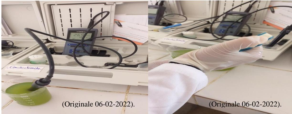
**Figure 16** : La mesure de la conductivité, la salinité et de température par conductimètre 3110.
