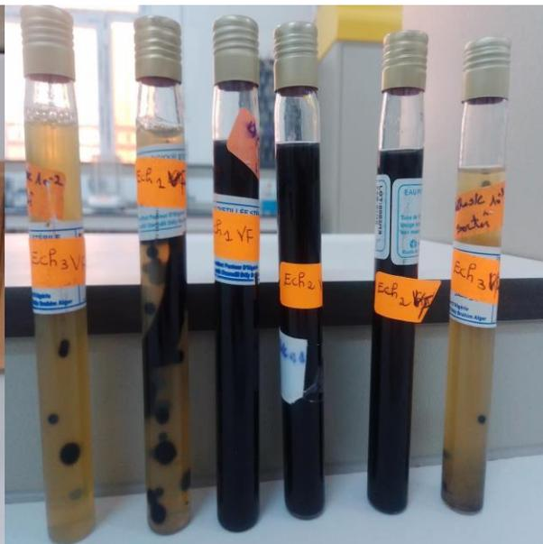
**Figure 07 :** résultats des spores des anaérobies sulfite réducteurs (ASR).
