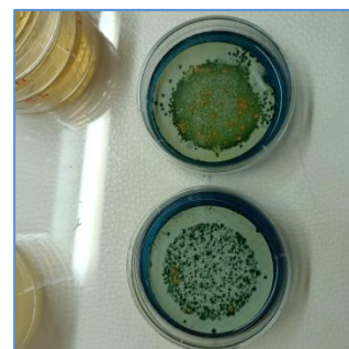
Lecteur des analyses coliforme totaux et fécaux /Lecteur des analyses Streptocoques / lecteur d'Erecheria Coli
