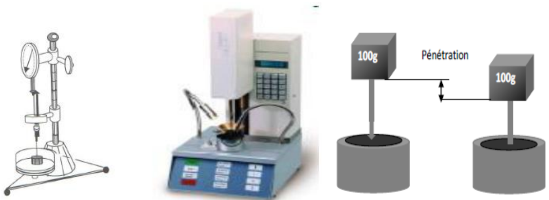
Figure III.5 : Appareillage et principe d'essai [57 ].
