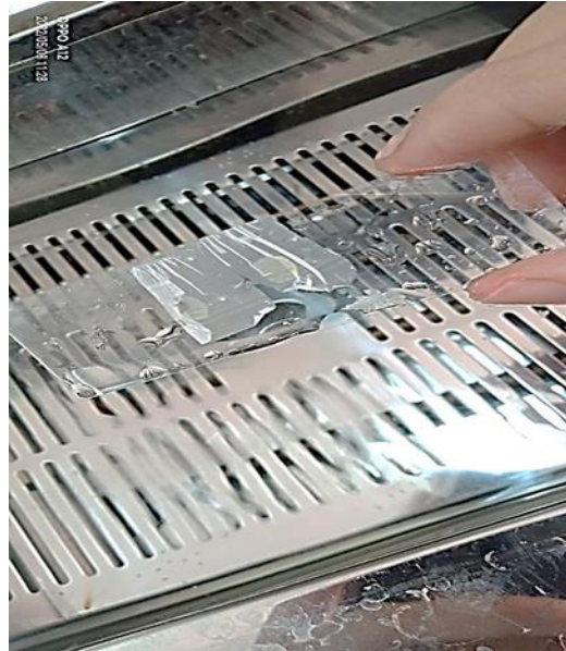
Figure 12. Etalement d'un ruban de paraffine contenant l'échantillon dans le bain marie (Bammoune et BabaAmmi, 2022).
