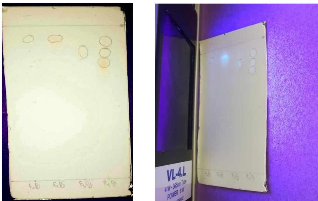
Figure 24 : Résultat de chromatographie sur couche mince de 4 fractions de Djelfa (Visible et sous UV à 365 nm)
