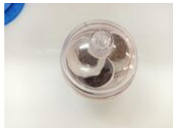
Photo III.12 : Photo de dessiccateur utilisé pour le refroidissement et la protection contre l'humidité.
