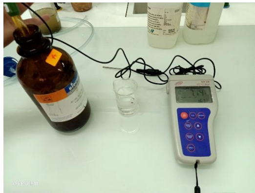
Photo III.15 : Dispositif de mesure de pH (AD 130 ph /mV Meter)
