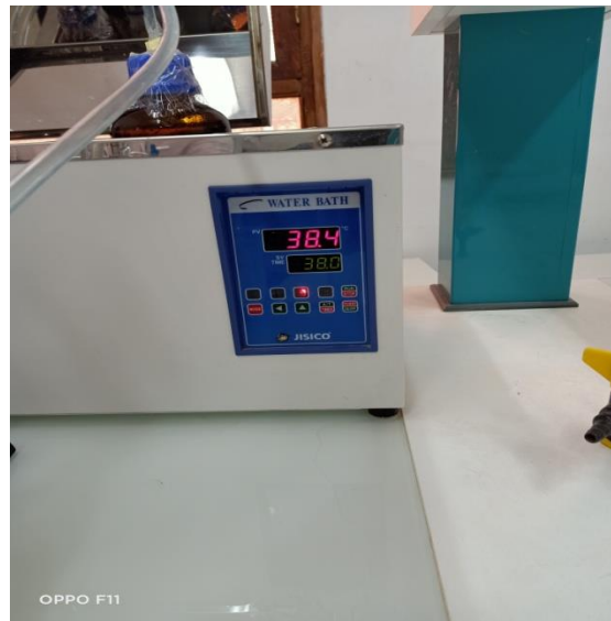
Photo III.8 : un bain marie chauffé est régulé à 38°C
