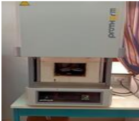
Photo III.13 : Four à moufle utilisé (PROTHERM)
