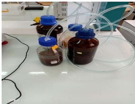
Photo III.6 : Les quater digesteurs préparés
