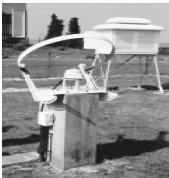
Figure I.9 : Pyrhéliomètre Eppley : mesure de la composante directe [9]
