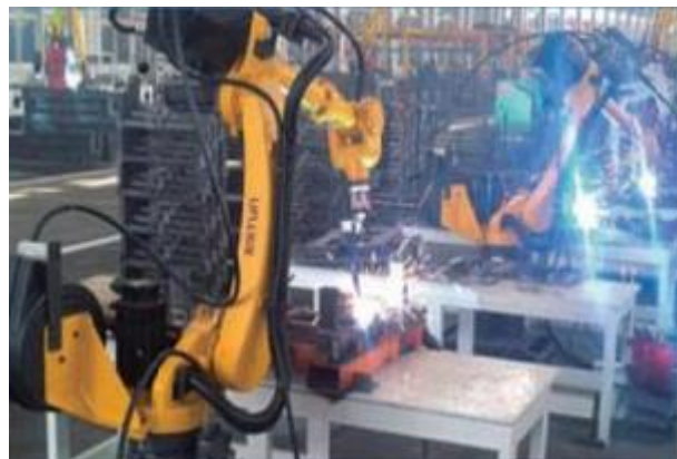
Figure 1-7 : Manipulateur à cycle pré-réglé.
