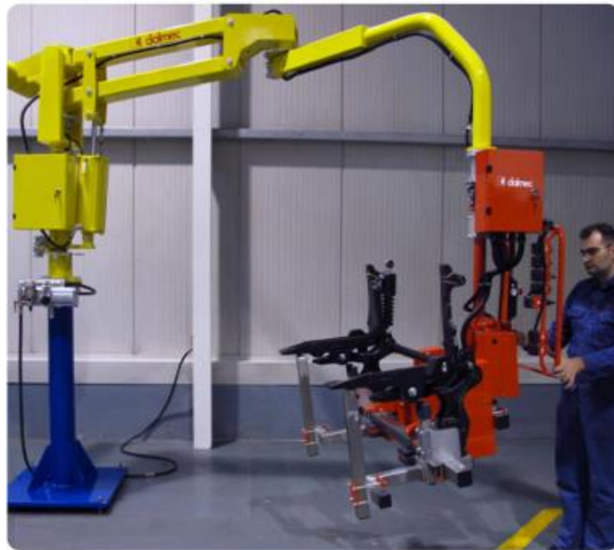
Figure 1-6 : Robot manipulateur à commande manuelle.
