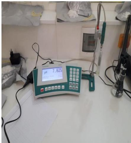
Figure III-01: anion mètre (pH mètre)
