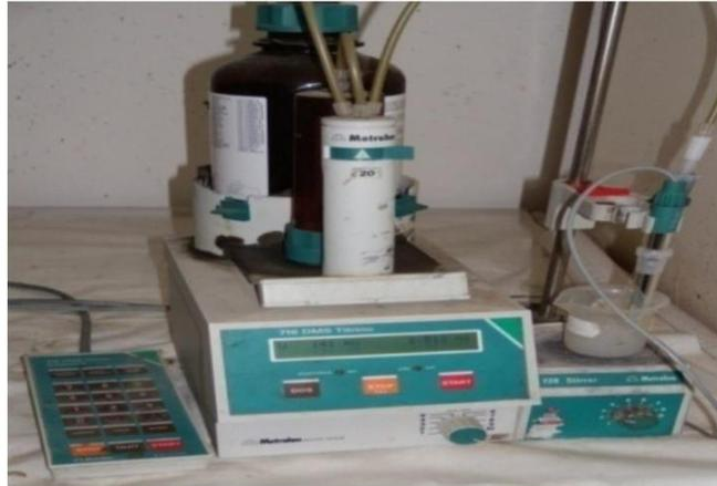
Figure (III-4) : Potentiomètre Titrino 716 Metrohm
