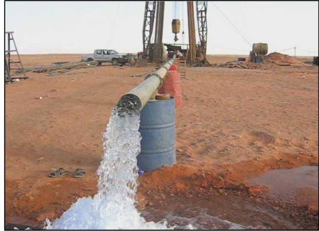
Annexe.12. Essai de pompage le forage C05.
