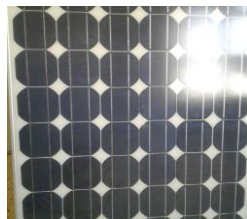
Figure 2-30 : Image réel de panneaux en silicium mono cristallin.
