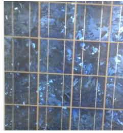
Figure 2-31 : Image réel de panneaux en silicium poly-cristallin.
