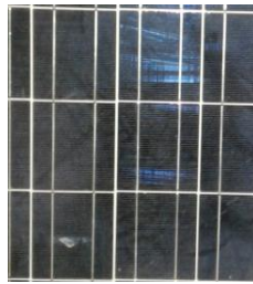
Figure 2-32 : Image réel de panneau en silicium amorphe (a-Si).
