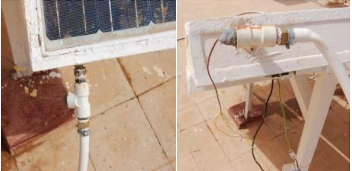
**Figure IV.13 : L'emplacement du thermocouple sur le capteur PV-T**
