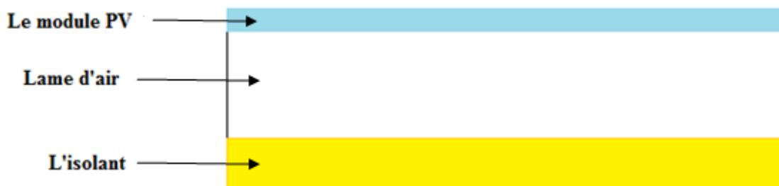
Figure IV.1: Capteur hybride PV-T à air
