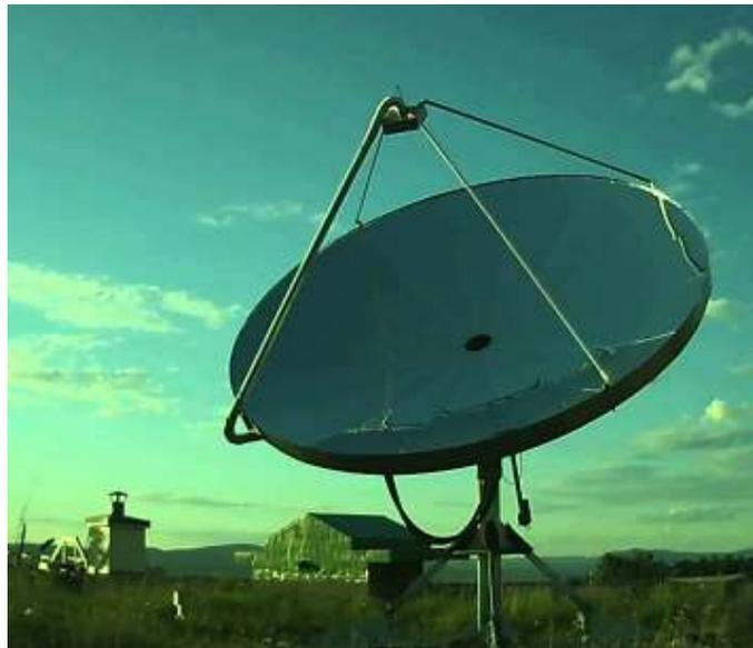
Figure III.4 : Concentrateur parabolique [84]
