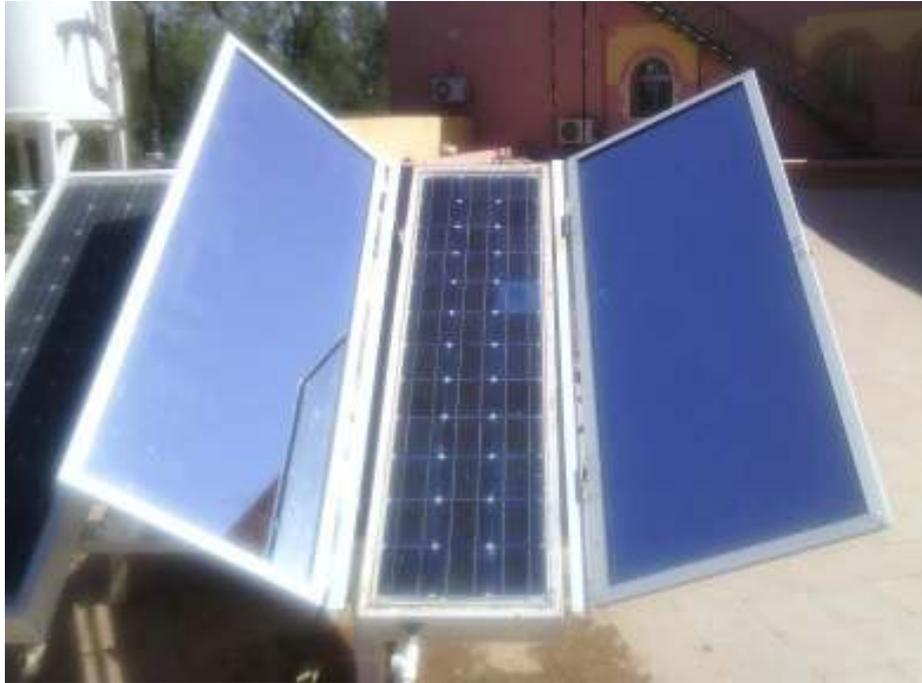
Figure IV.11 : Le capteur hybride PVT à eau avec concentrateurs
