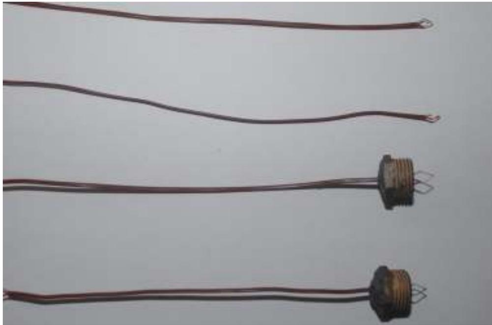
Figure IV.15 : Thermocouple de type K
